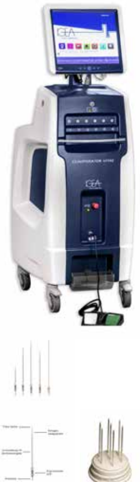
Abb. 1 Cliniporator VITAE, Elektroporationsgerät, IGEA S.p.A. Deutschland; Lineare und hexagonale Nadelsonden
